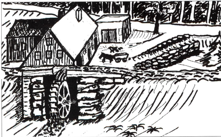
Rekonstruktionsversuch. Bedeutsam ist die Fortleitung des Mühlrad-Wassers über das Rad hinweg (bei Ruhen des Betriebs); danach setzt sich der Mühlgraben ca. 100 Meter weit fort.
