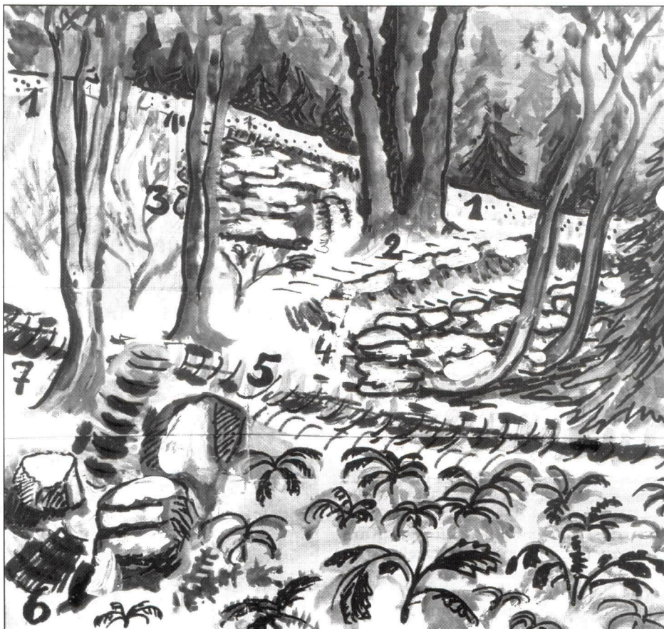
Die Trümmerreste der Unteren Sorgmühle, vom Bachbett aus gesehen: 1 = Waldsteig, 2 = schräge Abfahrt, 3 = Rückwand, 4 = Stützmauer, 5 = Mühlgraben, 6 = Radstube, 7 = Weiterleitung des Mühlbaches nach der Mühle.
