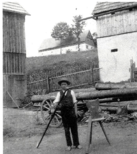
Der achtjährige Albin mit dem Schwert (die Scheide lehnt am Bauernstuhl). Links ein Eck der alten Scheune. Der eisenbereifte „Kipfwagen“ ist an der Längsachse („Langwied“) auseinandergezogen zum Langholztransport. Mit Kastenaufbau konnte er als „Truhenwagen“ Erdäpfel, Rüben, Getreidesäcke fassen, mit „Leitern“ bestückt Heu und Kornbüschel. (nach Herbert Strobel)
